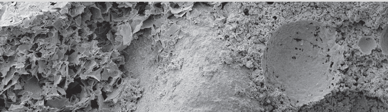
L'enduction microporeuse empêche une accumulation de condensation et protège ainsi contre des algues et de mousse.
