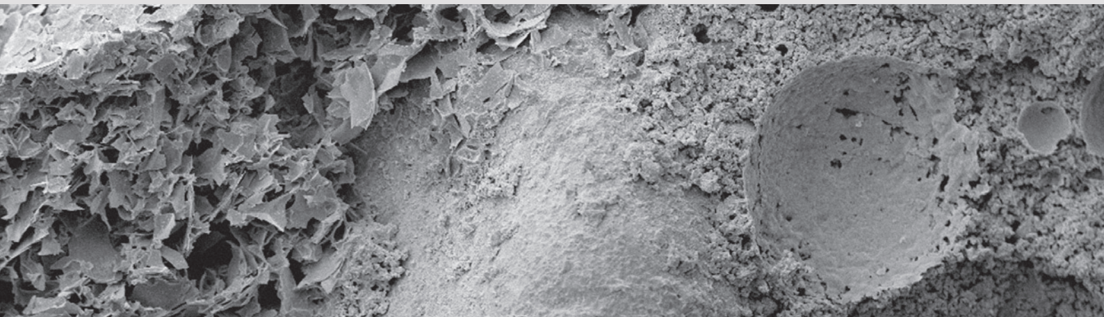
Mikroporenbeschichtung verhindert Kondensatansammlung und schützt somit gegen Algen und Moosbildung
